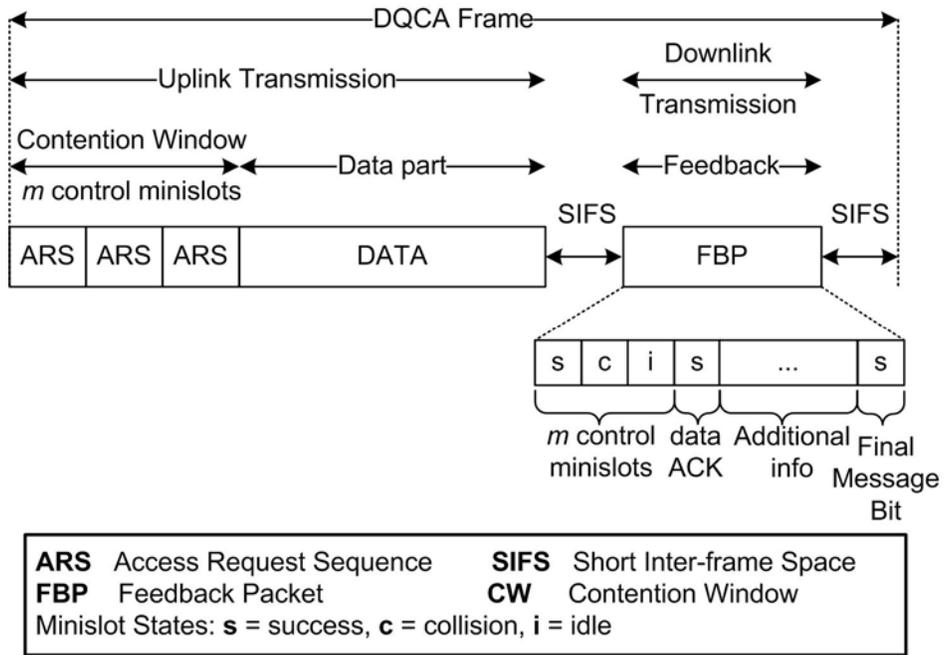
**Figure 1** DQCA Frame Structure
